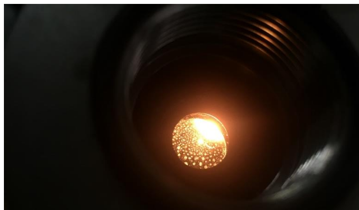
Figura 32 - Presença de condensados na lente ótica do medidor de cor
